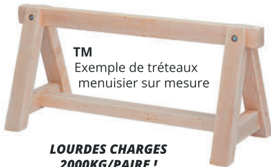
TM800X800 Exemple de tréteaux menuisier en 800 x 800 mm Piétement section 80 x 60 mm
