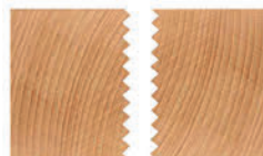
ASSEMBLAGE Collé et assemblé par joints dentés
