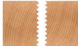
ASSEMBLAGE Collé et assemblé par joints dentés
