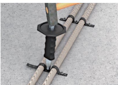
Fixation tube avec FixPin et bande de montage métallique
