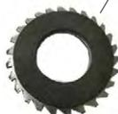
Disque de frein sur arbre cannelé, ce qui a pour but de diminuer l'usure, améliorer l'efficacité ainsi que la sécurité au niveau du freinage.
