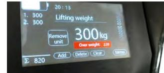
Écran tactile 4,3" multifonctions dont indication poids, charge des batteries, etc.
