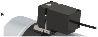
Utilisé pour la ventilation modulée en tertiaire, le registre motorisé **RM-ME bi-débit autorégulés** fonctionne en tout ou peu suivant une vanne pilotée par un moteur électrique. En position fermée, (hors tension) un volet plein équipé d'un régulateur de débit Ø 80 ou Ø 100 mm permet d'obtenir une partie du débit nominal.
