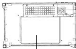
Le bloc moteur, fixé en dessous du socle, peut être facilement démonté à l'aide des 6 vis en cas de maintenance sans déplacer, ni basculer le vestiaire.
