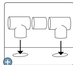
Montage rapide et facile du conduit d'aération (par emboîtement) afin d'évacuer l'air à l'extérieur
