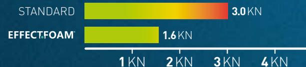
\* L'absorption d'énergie dynamique réduit les impacts à 1,6 kN, la moyenne pour les chaussures de sécurité étant de 3,0 kN.
