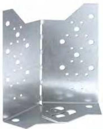
Les équerres ABF permettent la fixation de poutres bois servant de ceinture porteuse de dalle bois sur plot béton. Elles sont réglables en angle sur chantier et permettent ainsi d'obtenir un angle intérieur entre les poutres bois de 90 à 150°. Des perçages sur la pièce permettent un ajustement à l'angle souhaité.
