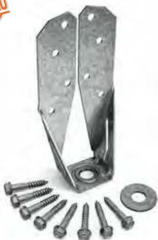
Les ancrages DTT2Z sont conçus pour des ancrages légers d'éléments de construction. Le DTT2Z se fixe facilement au bois à partir de 38 mm d'épaisseur avec les vis de connecteur Simpson Strong-Tie Strong-Drive SDS incluses. Il s'adapte à une tige filetée de 12 mm ou à un ancrage à béton de Ø12 mm.
