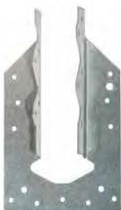
Le pied de chevron PFP permet de raccorder un chevron avec la sablière à un poteau. Il assure ainsi la reprise du soulèvement des fermes situées au droit des pignons.
