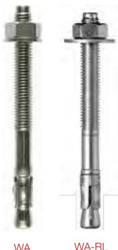
Les goujons d'ancrage sont des systèmes de fixation par expansion pour charges moyennes. Le goujon d'ancrage WA-RL possède une rondelle large pour pouvoir fixer des éléments bois.
