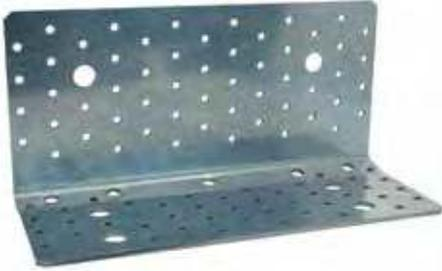
L'équerre AB255HD a été développée pour la construction CLT. Elle est capable de résister aux sollicitations latérales et verticales. De plus, quand elle est installée avec des vis à filetage total, elle est particulièrement résistante au soulèvement, tout en pouvant être dissimulée sous une chape béton.
