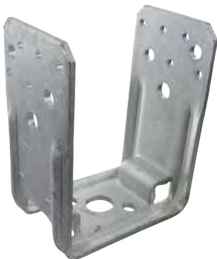
Les embases de poteaux PU permettent la fixation de poteaux sur un support existant (balcon, terrasse...) et assurent la protection du poteau des remontées d'humidité (repos à 20 mm du sol).
