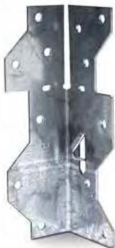
L'équerre pliable A35 présente deux atouts majeurs : le Speed Fix qui permet le prépositionnement de l'équerre avant le clouage et deux parties pliables sur chantier qui permettent, suivant les configurations, de reprendre des efforts jusqu'à 3 directions.
