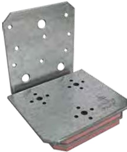
L'équerre acoustique ABAI est une équerre innovante car elle associe une équerre classique à un matériau d'isolation acoustique. Elle permet la connexion entre éléments de mur et de plancher en panneaux multiplis (CLT), tout en garantissant une isolation phonique grâce à une bande préinstallée de 12 mm sous l'équerre.
