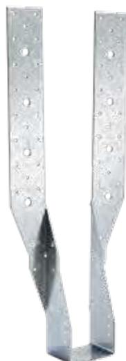
Le sabot à bretelles type THAI a la particularité de pouvoir être réglé en hauteur en rabattant les ailes sur le porteur suivant le type de configuration souhaité.
