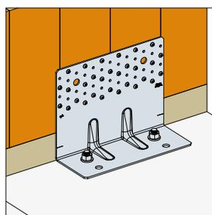
Équerre renforcée pour CLT avec vis inclinées **AB255HD**
