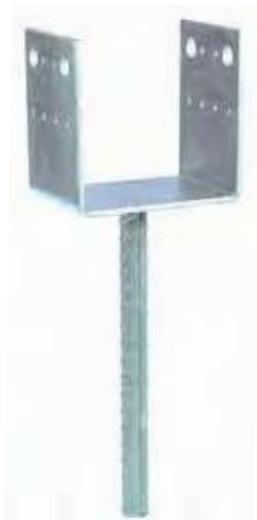
Les pieds de poteau en U à sceller PPD ont été conçus pour faciliter le montage. L'installation dans le béton nécessite des réservations mais permet de régler les niveaux avant de couler le béton.
