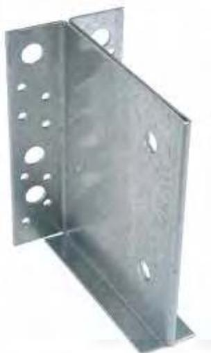
Cet étrier à âme intérieure permet un assemblage discret sur support bois. Le talon inférieur positionne l'étrier par rapport au bois facilitant le montage des broches.
