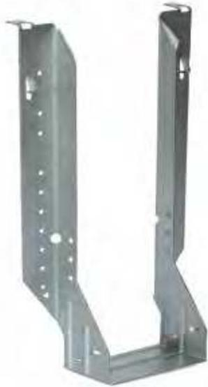
Les étriers IUSE garantissent une mise en œuvre facilitée grâce aux ergots supérieures, tout en assurant un maintien de la membrure basse par strong grip. Le clouage s'effectue sur les brides latérales après un pré-positionnement possible avec le speed prong.
