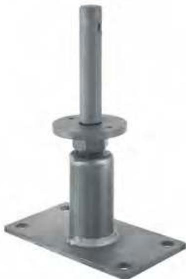
Le pied de poteau PGS24/130 a été conçu pour reprendre des charges verticales et horizontales. Il peut supporter de fortes charges en compression. Son caractère réglable permet un ajustement de la hauteur du poteau bois de 130 à 195 mm par rapport au sol. Enfin, la connexion au poteau est réalisée par un tube Ø24 mm qui s'insère dans le poteau pour un résultat discret.
