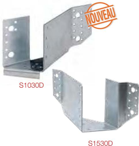
Le sabot à angle variable pour bois de fermette a été étudié pour des assemblages compris entre 10° et 30° ou 15° et 30°. Il est décliné pour les fermettes (38 mm) et fermettes doublées (80 mm).
