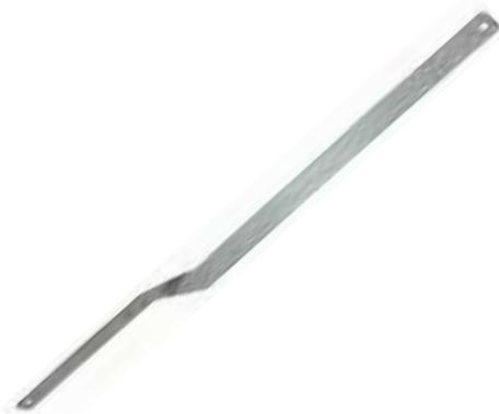
Les feuillards torsadés MTS assurent une résistance à la traction entre 2 éléments. Plus adaptés aux charpentes et aux contrevenements, ces feuillards offrent de nombreuses fonctionnalités. Le coude permet le pliage à 90° dans le sens de la longueur permettant ainsi l'assemblage d'éléments croisés à 90°.
