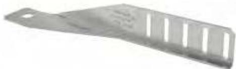
Les pattes pour murs rideaux CCW, modèles droite ou gauche, sont des équerres dont le but est de connecter les montants bois des murs rideaux à une dalle de béton. Ils offrent la possibilité d'avoir une distance de 50 mm entre les deux éléments. Ces pattes ont été conçues pour supporter des charges perpendiculaires aux fibres du bois (compression-tension), et permettent un libre mouvement du montant, dans le sens des fibres, jusqu'à +/- 10 mm.
