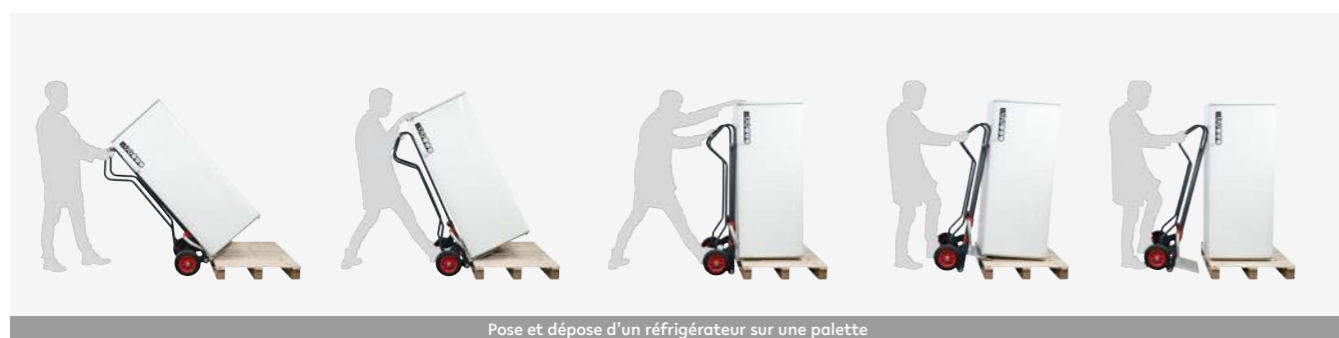
Pose et dépose d'un réfrigérateur sur une palette
