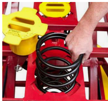
Mise en place de ressorts pour réglage des charges
