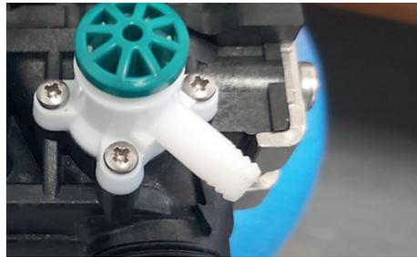
**19** Prendre un échantillon d'eau au niveau de la vanne test d'entrée (appuyez sur le bouton vert pour faire couler l'eau).
