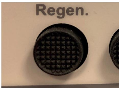
**11** Appuyer sur la touche "Regen" pendant 5 à 6 secondes jusqu'au démarrage du moteur, puis relâcher.
