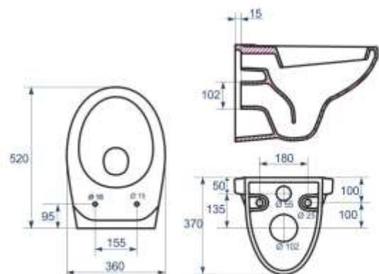
Pack pour WC suspendu EVO à commande mécanique
