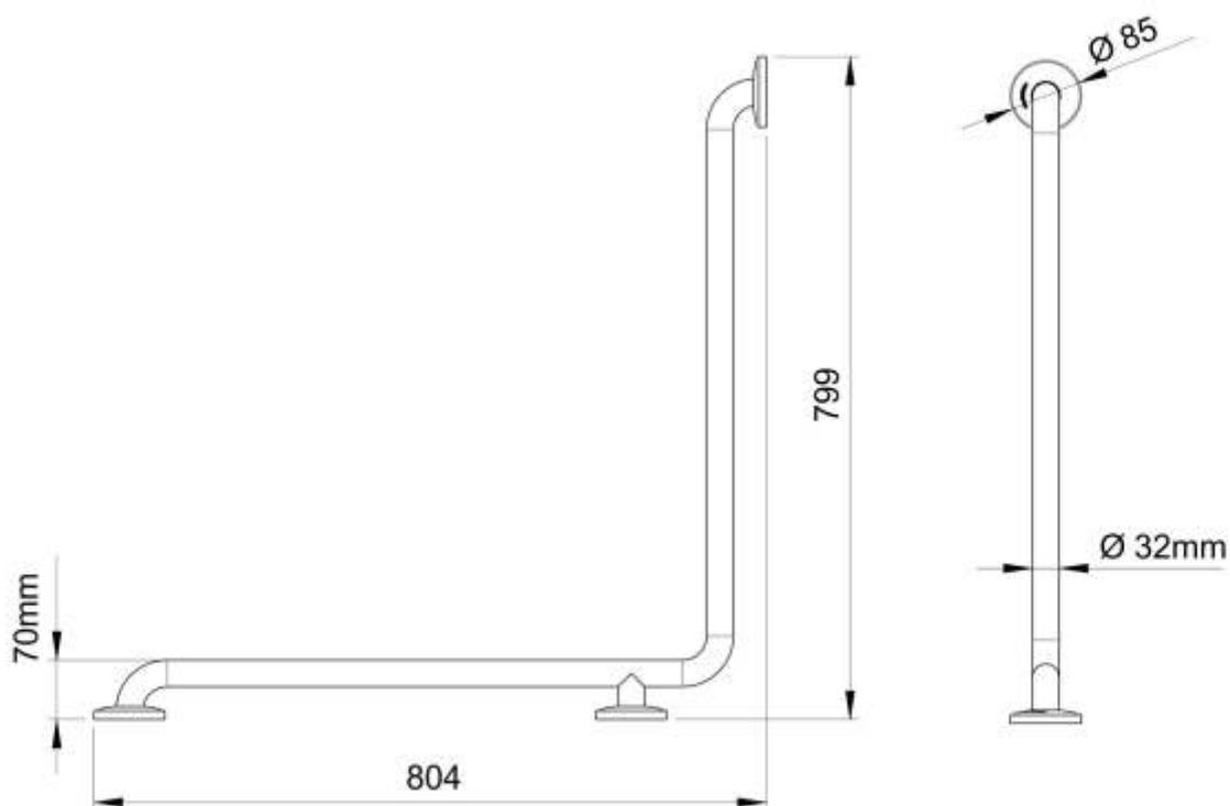
Barre d'appui d'angle à 90° droite ou gauche, en acier inoxydable, finition satinée
