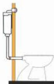
\* peut également être monté avec une cuvette suspendue associée à un bâti indépendant
