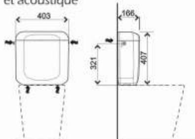
Robinet flotteur silencieux NF classe 1 à remplissage différé
