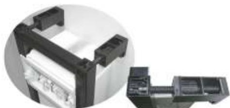
Fixations murales en matière de synthèse pour bâti-support mural ou universel, réglables en profondeur jusqu'à 240 mm. Long mini: 150 mm, larg.40 mm, haut. 67 mm.
