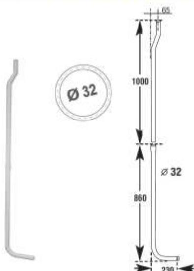
Ø Tube de chasse Ø 32 mm x H 186 cm en 2 éléments pour réservoir haut à chaînette.
