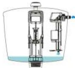
Le robinet flotteur reste fermé pendant le vidage du réservoir, le remplissage démarre lorsque le volume d'eau est libéré.
