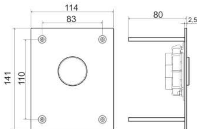
Boîtier de pré-installation à encastrer pour commande temporisée 1615iB
