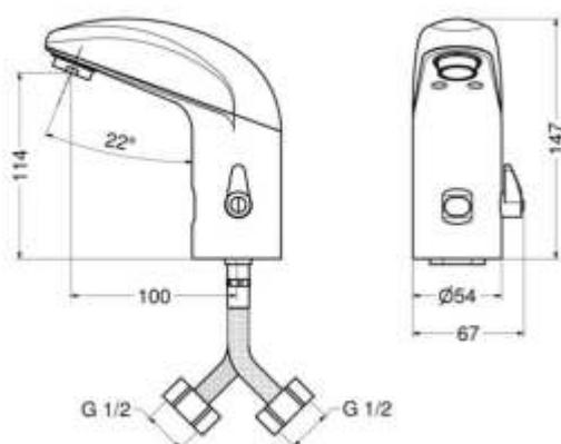
Robinet mural de lavabo électronique à détection infrarouge et alimentation à piles
