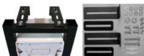
Fixations murales en métal pour bâti-support CESAME autoportant ou universel, réglables en profondeur jusqu'à 250 mm avec chevilles, vis et visserie. Long mini: 145 mm, larg platine: 50 mm, hauteur équerre : 60 mm
