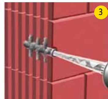
3. Glisser la poche souple dans le pistolet, introduire l'embase de l'embout dans le tube, visser la bague de verrouillage. Extruder la résine jusqu'à l'obtention d'une couleur uniforme. Introduire le mélangeur jusqu'au fond du tamis et extruder en reculant au fur et à mesure. Remplir complètement le tamis.
