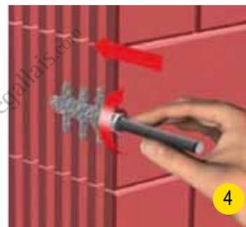
4. Introduire la tige filetée ou la douille en exerçant une légère rotation. Respecter le temps de durcissement, positionner la pièce à fixer.
