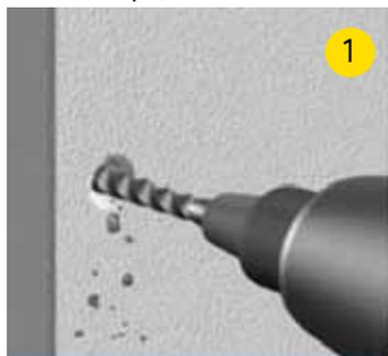
1. Percer un trou de diamètre et profondeur adéquats pour l'installation de la tige filetée ou de la douille.
