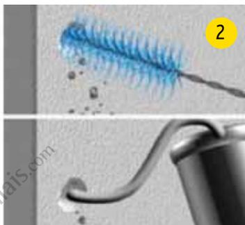
2. Nettoyer soigneusement en réalisant 2 soufflages, 2 passages d'écouvillon, puis à nouveau 2 soufflages et 2 passages d'écouvillons et finalement 2 soufflages.
