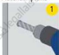
Percer un trou de diamètre et profondeur adéquats pour l'installation de la tige filetée ou de la douille.
