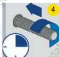
Introduire la tige filetée ou la douille en exerçant une légère rotation. Respecter le temps de mise en charge, positionner la pièce à fixer.
