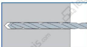
1. Percer au travers un trou de 6 mm de diamètre à la profondeur requise
