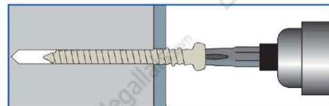
3. A l'aide d'un embout adéquat visser la vis béton au travers de la pièce à fixer dans le matériau support.
