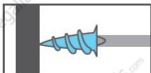
1. Positionner la pièce à fixer et repérer les emplacements. À l'aide d'un tournevis pozidriv n°2, pousser la cheville dans le support pour créer un petit avant-trou.
